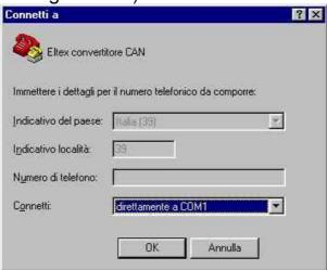
settare i parametri della porta a 19200, 8N1 senza controllo di flusso (vedi disegno sotto)
