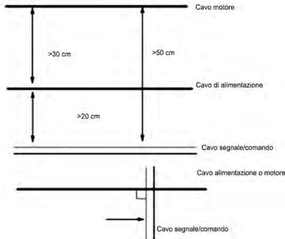
In generale i cavi di comando devono essere schermati e la rete metallica di schermatura deve essere collegata all'involucro metallico dell'inverter mediante morsetti per cavi.
