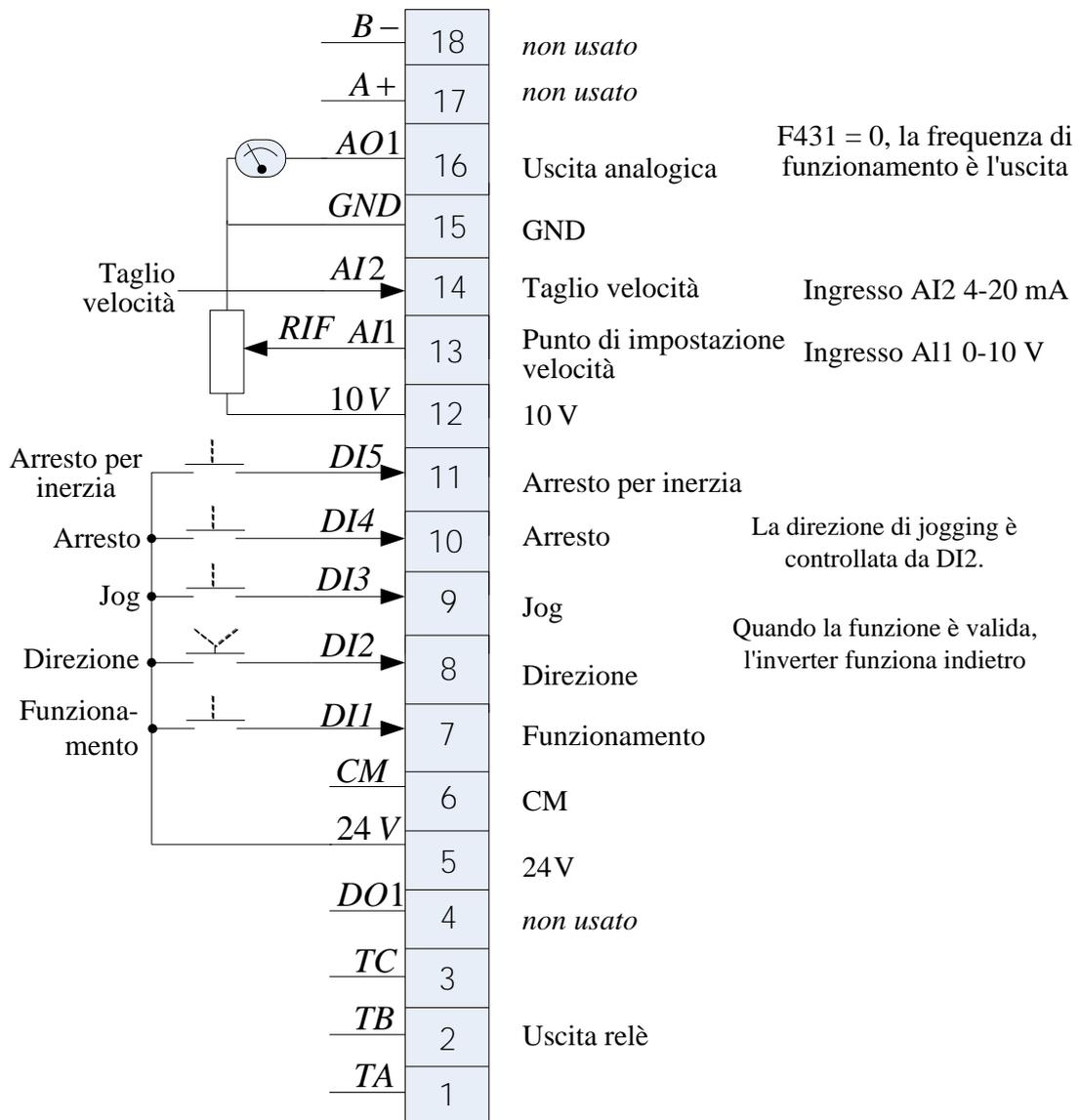
Applicazione 1: comando della velocità di base
