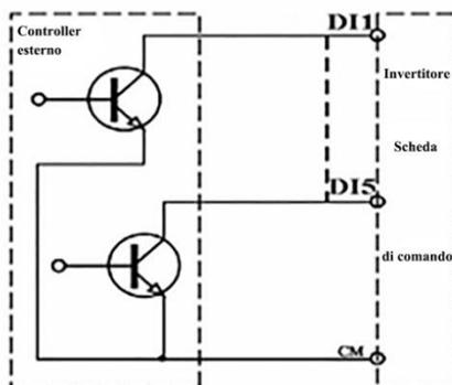
Se i morsetti di ingresso di comando digitale sono collegati mediante l'elettrodo di scarico, spostare l'interruttore sul lato "PNP". Cablaggio per i morsetti di comando come di seguito:
