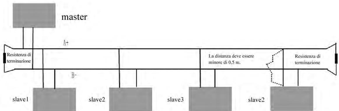
Diagramma di collegamento delle resistenze di terminazione
