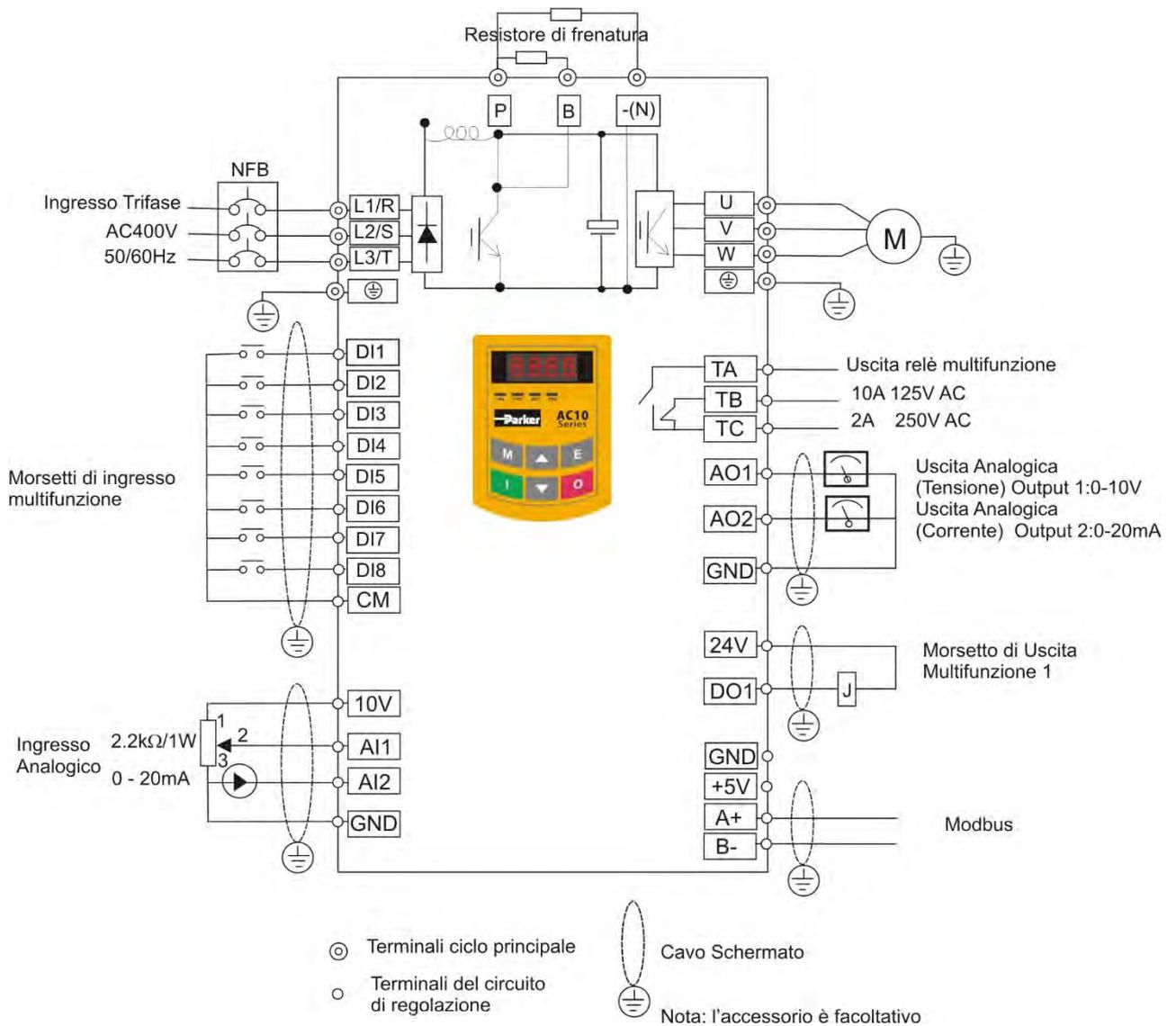
30kW - 180kW di base Schema di cablaggio per inverter trifase (tipo NPN)
