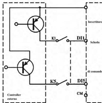
Il cablaggio mediante l'elettrodo sorgente è una modalità molto utilizzata attualmente. Il cablaggio per i morsetti di comando è collegato mediante l'elettrodo sorgente, l'utente deve scegliere la modalità di cablaggio secondo i requisiti.
