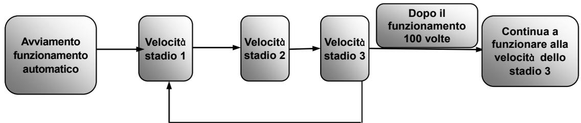
Figura 9-10 Funzionamento automatico
