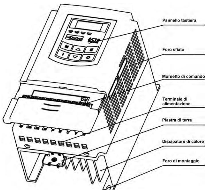
Contenitore metallico (modello 6 – 11) utilizza avanzate esterno plastica- irrorazione e polvere spruzzando processo sulla superficie con il colore e la struttura staccabile Cerniera un lato ADOTTATO per la copertura anteriore, conveniente per il cablaggio e la manutenzione. Prendendo 10G 46-0060, per esempio, il suo aspetto e la struttura sono riportati di seguito.
