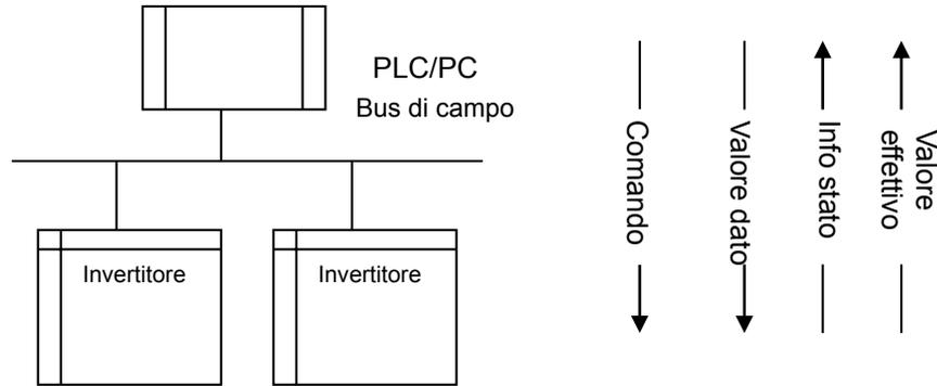
Diagramma di collegamento del bus di campo
