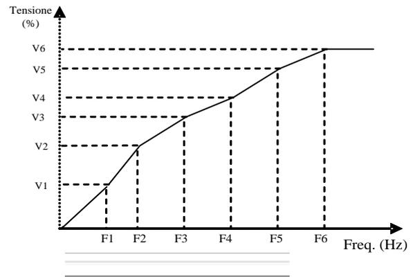
Figura 9-4 VVVF di tipo a linea poligonale
