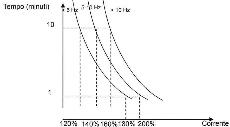
Figura 9-13 Valore della protezione da sovraccarico del motore
