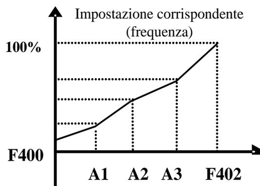
Figura 9-9 Segnale analogico spezzato con valore di impostazione
