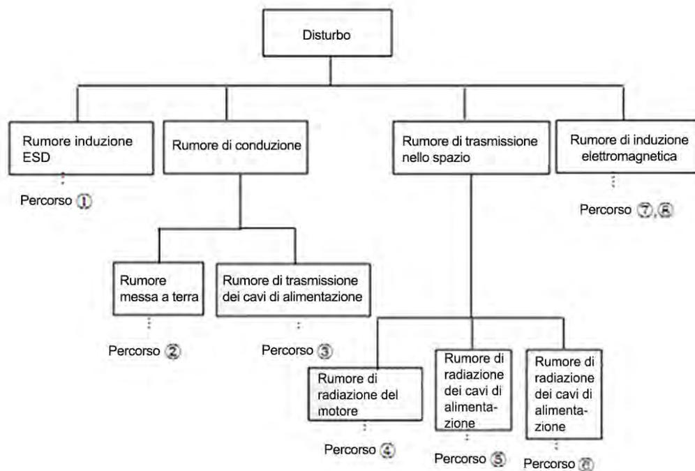
③ Percorsi di propagazione del disturbo
