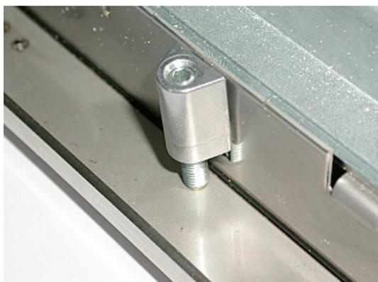
Figura 4-4 Sede corretta della zepa di serraggio
