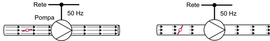
Figura 6-67 Regolazione del flusso con pompa e valvole a farfalla su rete a 50 Hz
