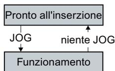
I comandi "Funzionamento a impulsi 1" o "Funzionamento a impulsi 2" inseriscono e disinseriscono il motore.
