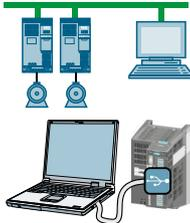
**STARTER** o **Startdrive** sono tool per PC che consentono di eseguire la messa in servizio, la diagnostica e il controllo del convertitore, nonché di salvarne e trasferirne le impostazioni. Il PC può essere collegato con il convertitore tramite USB o tramite il bus di campo PROFIBUS / PROFINET.
