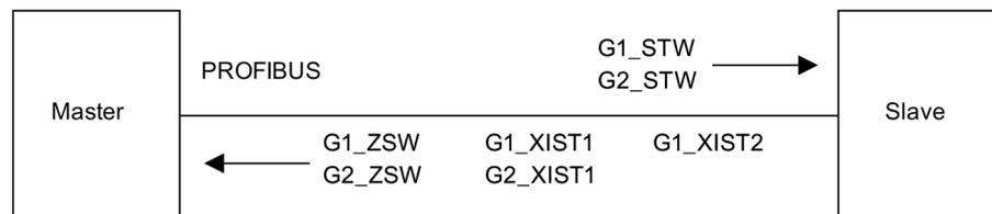
Figura 10-4 Esempio di interfaccia dell'encoder (encoder -1: due valori attuali, encoder -2: un valore attuale)
