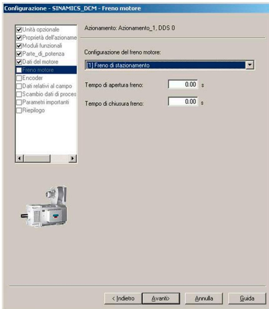
Figura 8-21 Freno del motore
