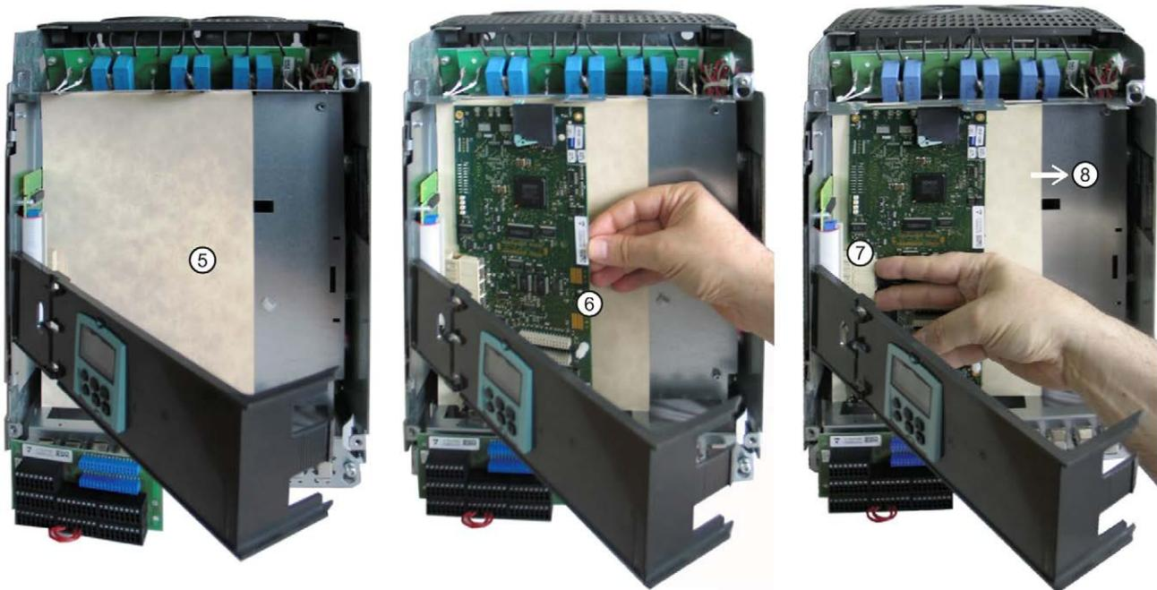
Figura 11-12 Sostituzione della CUD, 2
